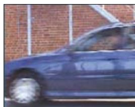
Le balayage entrelacé produit une différence de 20 ms entre les lignes paires et impaires
