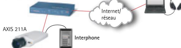
Les fonctions d'alimentation PoE et de transmission audio intégrées réduisent le câblage et les frais d'installation en permettant de brancher les caméras et le système audio bidirectionnel sur le réseau
