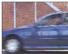
Balayage entrelacé : différence de 20 ms entre les lignes paires et impaires
