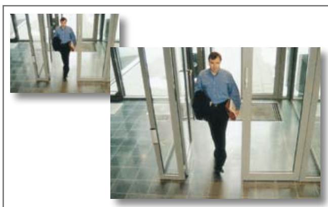
Balayage entrelacé : différence de 20 ms entre les lignes paires et impaires
